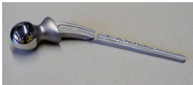
Abbildung 5.15: Gebrochene Monoblock St. Georg Hüftendoprothese. Die am Schaft erkennbaren Beschädigungen wurden durch die Schrauben einer langen Osteosyntheseplatte nach peri-prothetischer Fraktur herbeigeführt. Die Prothese brach an einer Stelle proximal der ersten erkennbaren Implantatschädigung und nicht – wie zu erwarten – an den Kerben. Inwieweit auch an dieser Stelle durch die Osteosynthese ein Schaden gesetzt wurde oder die Implantatprägung zu einer Kerbspannungskonzentration geführt hat, kann nicht festgestellt werden (Implantat von Fa. Link zur Verfügung gestellt)
