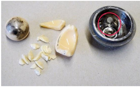
Abbildung 5.16: Bruch eines keramischen Inlays. In der Metallpfanne ist das Eindringen des Keramikkopfes in die weiche Titanschale zu erkennen (am oberen Schraubenloch). Folglich hat der Patient nach Fraktur des Inlays das Gelenk über einen längeren Zeitraum weiter belastet. Dieses schlägt sich auch in der Schwarzfärbung des Keramikkopfes nieder. Der Ursache für die Inlayfraktur kann anhand des Explantates nicht bestimmt werden (Implantat von PD Dr.med. Honl zur Verfügung gestellt)
