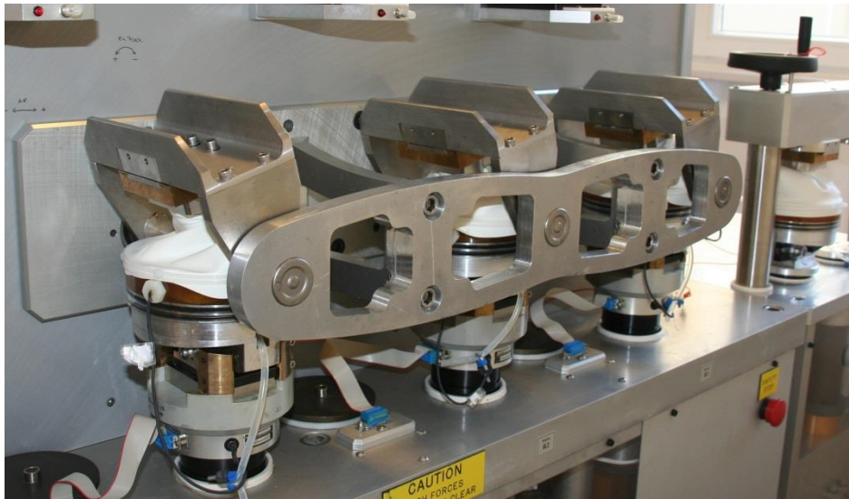
Abbildung 5.13: Beispiel für einen Simulator, der die Belastungen im künstlichen Kniegelenk nachbildet (Klinik für Orthopädie und Unfallchirurgie, Universitätsklinikum Heidelberg)
