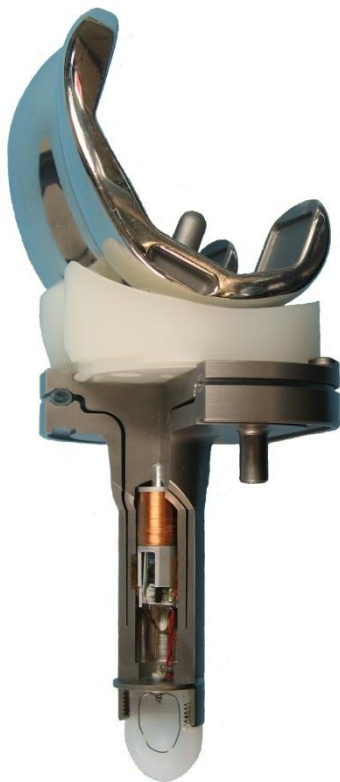
Abbildung 5.9: Instrumentierte Knieendoprothese zur telemetrischen Belastungsmessung im Patienten
