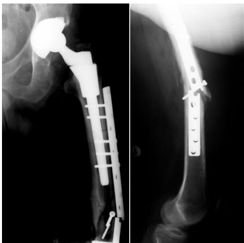
Abbildung 5.19: Bruch einer Osteosyntheseplatte nach peri-prothetischer Fraktur und verzögerter Knochenheilung. Die peri-prothetische Fraktur trat 4 Wochen post-operativ auf, der Implantatbruch 12 Monate nach Frakturversorgung. Der Plattenbruch weist nicht auf einen Schaden im Implantat hin. Ursache für den Schaden war die verzögerte bzw. nicht stattgefundene Knochenheilung, da diese zur Dauerbelastung des Implantates führte. Knochenplatten sind jedoch nicht für eine hohe Dauerbelastung ausgelegt (Implantat von PD Dr.med. Honl zur Verfügung gestellt)
