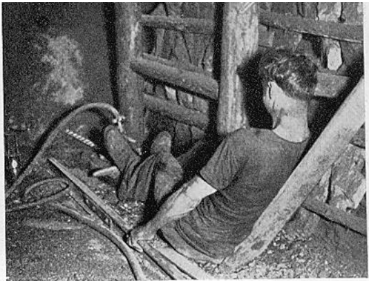
Abb. 16. Bohren eines Sohlenschusses.
